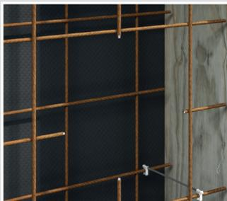
Coffrage avec ferraillement préparé vu du côté de partie du contre-coffrage.
