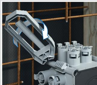
Bei Korrektur den Flügel um 180° drehen und neu anbringen.
