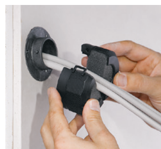
1 FX 4 Verschraubung | 2 Schottzylinder zweiteilig | 3 Dichtelement
