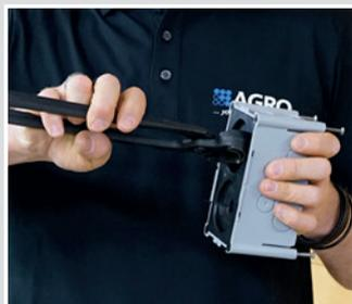
Putzborsten mit Zange abtrennen. Schutzdeckel darf nicht entfernt werden.
