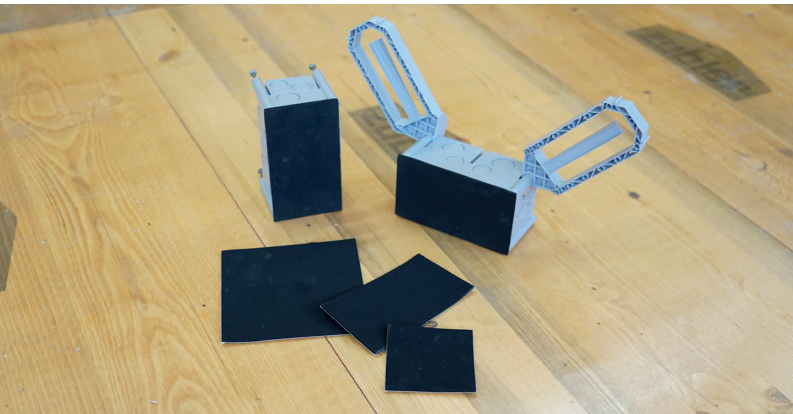
Beim Abschluss zwischen Beton und Installationsdose ermöglichen die Prenaplaten aus 2 mm dickem Neopren einen saubereren Übergang. Die Platten verhindern Aussandungen und Verfärbungen, indem das Unterfließen von Beton unterbunden wird. Die Prenaplaten haben auf einer Seite eine starke Klebefläche, welche auf die Installationsdosen geklebt werden. Ein verrutschen der Platten während der Betonierphase wird somit verhindert.
